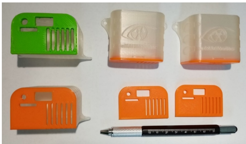
Obr. 7.4: Kryty a ochranné krabičky z PLA pre enviromentáln senzory. Na pere vedľa dvoch oranžových krytov je vidieť mierku v centimetroch.
