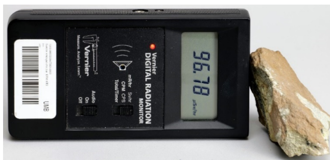
Obr. 4.8: Meranie aktivity uraninitu pomocou GM detektora Vernier TH30044.
