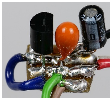
Obr. 3.6: Stabilizátor napätia LP2950ACZ-3.3/NOPB s 1 \mu F a s 2,2 \mu F kondenzátormi, umiestnený na plošnom spoji a napájaný 5 V DC výstupom Arduino.
