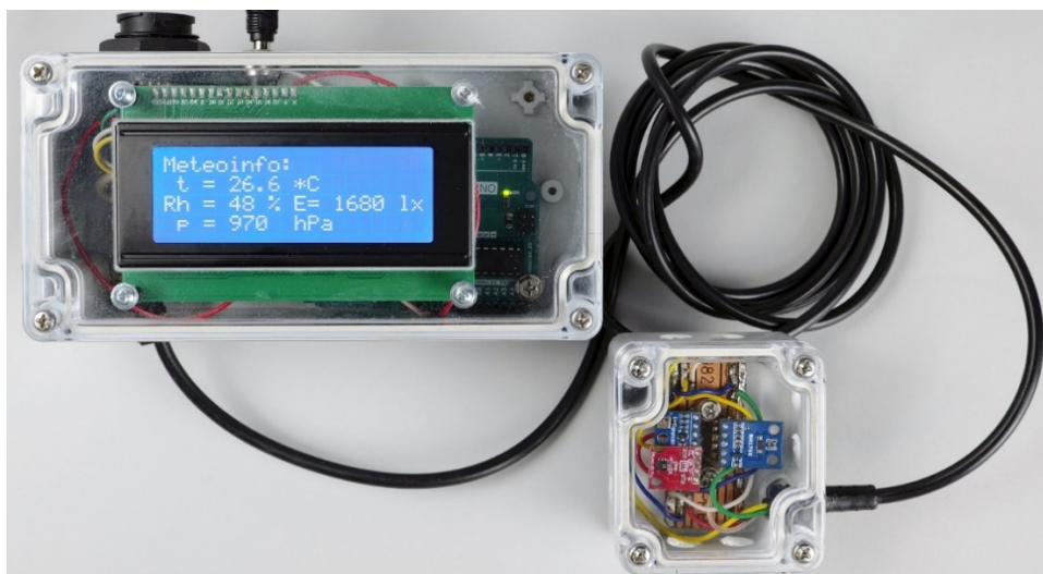
Obr. 5.1: Jednoduchá meteorologická stanica s mikrokontrolérom Arduino Uno.
