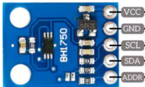
Obr. 5.4: Senzor BH1750, určený na meranie intenzity osvetlenia v luxoch.
