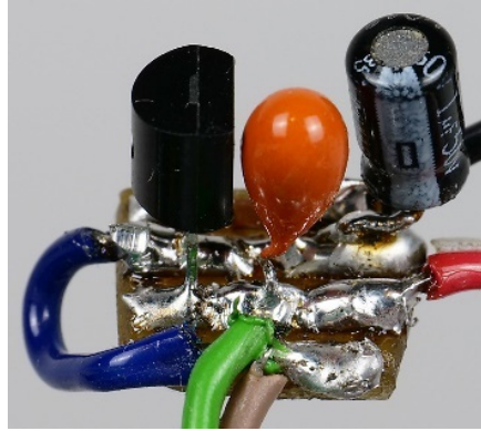
Figura 6. Stabilizator de tensiune LP2950ACZ-3.3 / NOPB cu condensatori 1 \mu\text{F} și 2.2 \mu\text{F} , amplasat pe PCB și alimentat de ieșirea de 5 V DC a Arduino
