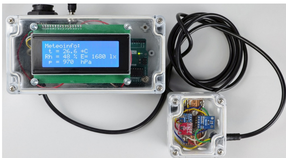
Figura 1. Stație meteorologică simplă cu microcontroler Arduino Uno
