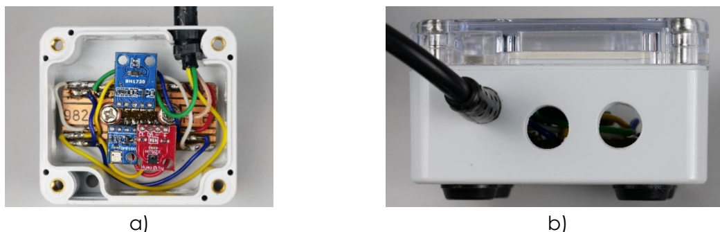
Figura 9a, b. Montarea senzorilor pe placa de circuit printat și fixarea plăcii cu senzorii în cutia de asamblare cu carcasă transparentă (a), vedere asupra găurilor date în partea laterală a cutiei (b)
