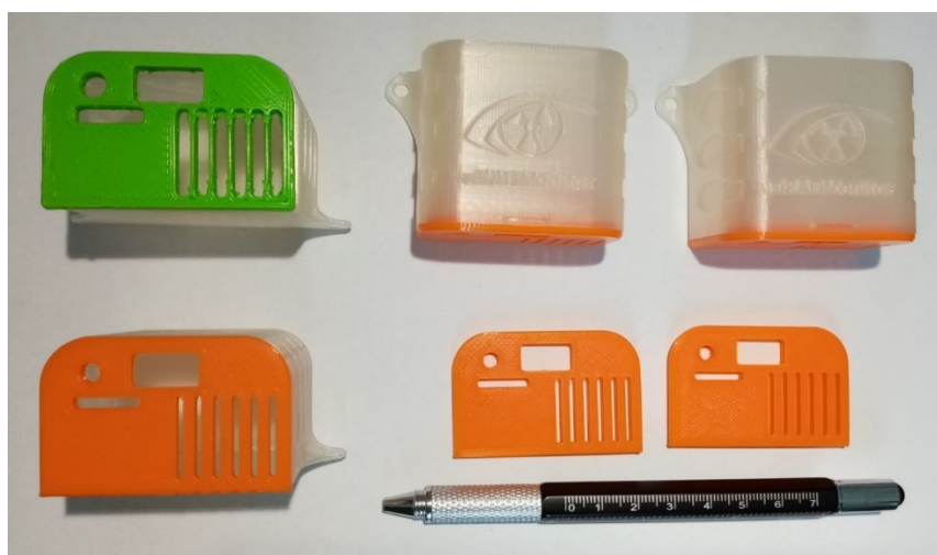
Figura 4. Capace și cutii de protecție pentru senzorii de mediu – se poate vedea scala (cu ajutorul pixului de lângă cele 2 capace de culoare portocaliu). Au fost realizate din PLA.
