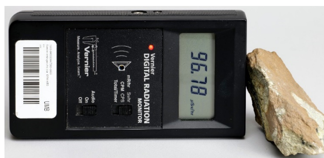
Figura 8. Măsurarea activității uraninitului folosind detectorul GM Vernier TH30044
