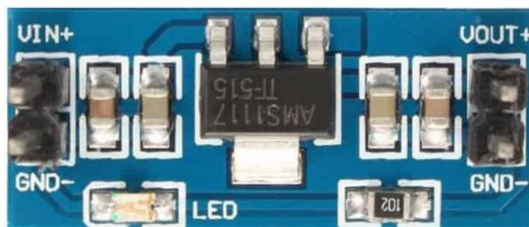
Figura 5. AMS1117 stabilizator de tensiune de 3,3V, alimentat de ieșirea 5V DC a Arduino
