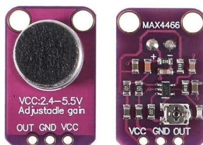
Фигура 4. Електретен микрофон с операционен усилвател MAX4466
