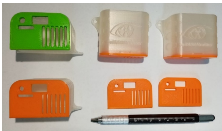
Фигура 4. Капаци и защитни кутии за сензори за околната среда – можете да видите скалата (като използвате писалката до двата оранжеви капака). Те са изработени от PLA.
