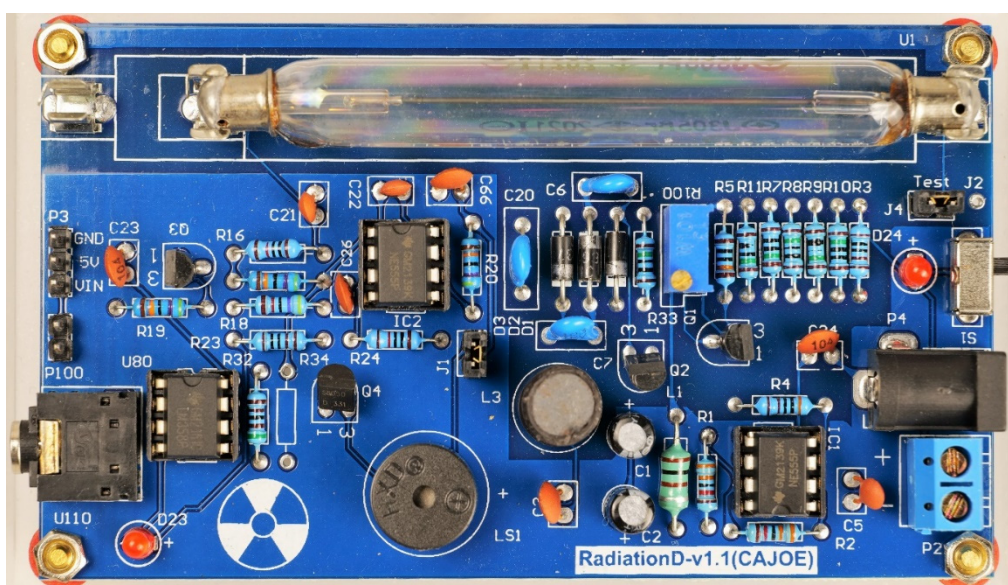
Фигура 4. GM детектор RadiationD-v1.1(CAJOE) с J305β тръба
