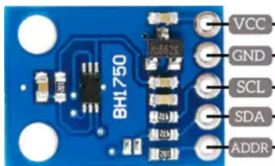
Фигура 4. BH1750 сензор, предназначен за измерване на интензивността на осветлението в луксове (lx)
