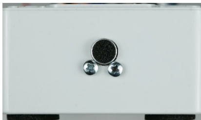
Фигура 12. Монтиране на сензора за микрофон
