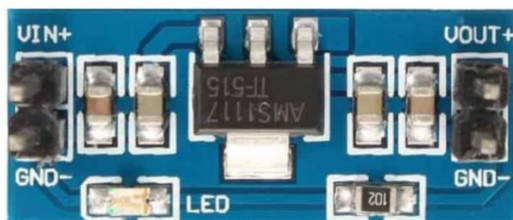
Фигура 5. Стабилизатор на напрежение AMS1117 3,3 V, захранван от 5V DC изход на Arduino
