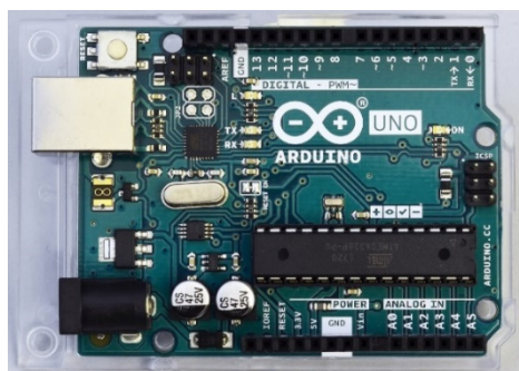
Фигура 3. Микроконтролер Arduino Uno (a) заедно с LCD дисплей (b)
