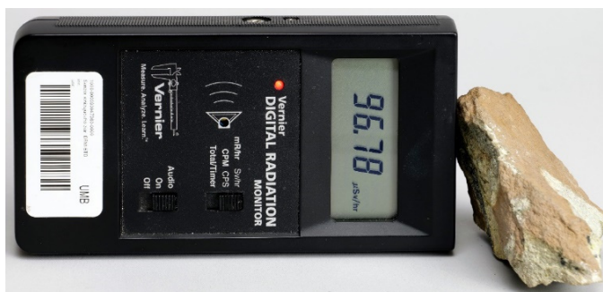
Фигура 8. Измерване на активността на уранинит с помощта на GM детектор Vernier TH30044
