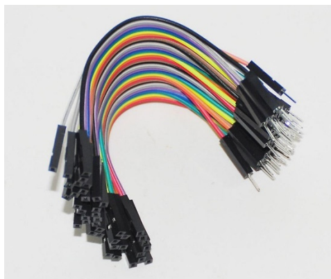
Фигура 10. Проводници с M-F клеми за свързване към Arduino
