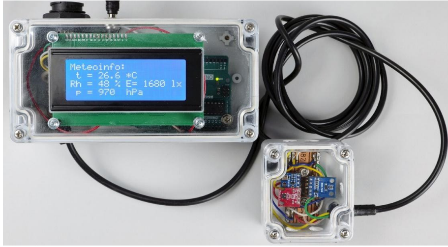
Şekil 1. Arduino Uno mikro denetleyicisine sahip basit meteoroloji istasyonu
