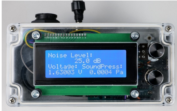
Şekil 1. Arduino Uno mikrodenetleyicili ses ölçer
