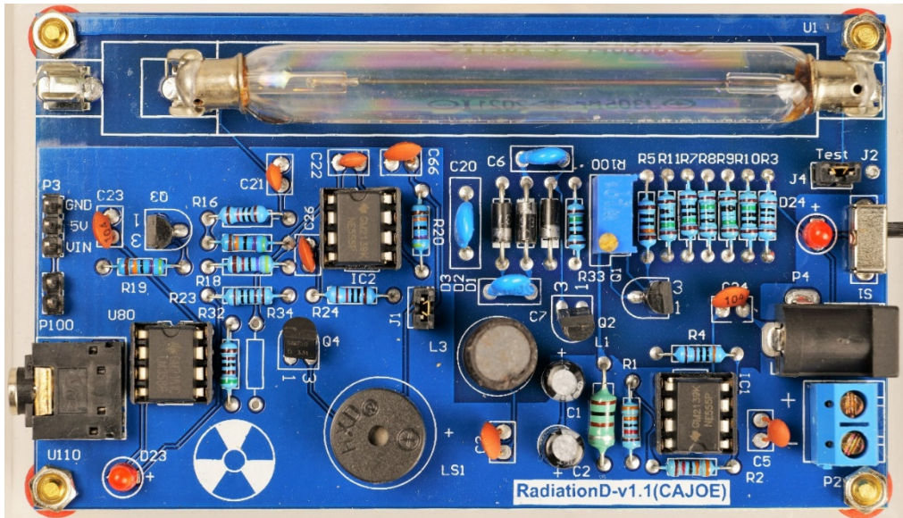
Şekil 4. J305β tüplü RadiationD-v1.1(CAJOE) GM dedektörü
