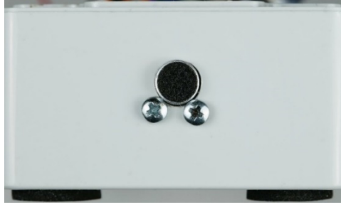
Şekil 12. Mikrofon sensörünün montajı
