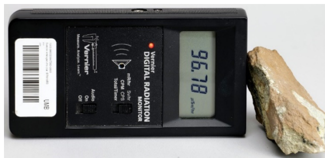
Şekil 8. GM Dedektör Vernier TH30044 kullanarak uraninit aktivitesinin ölçümü
