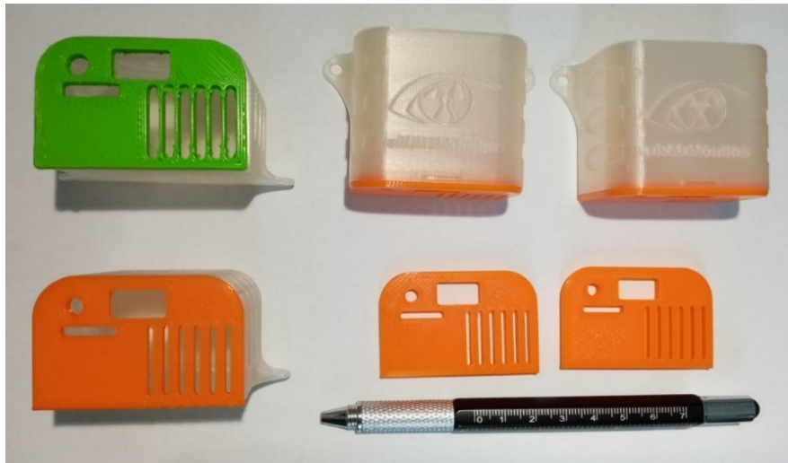
Şekil 4. Çevresel sensörler için kapaklar ve koruyucu kutular – (iki turuncu kapağın yanındaki kalemi kullanarak ölçeği görebilirsiniz). PLA'dan yapılmışlardır.
